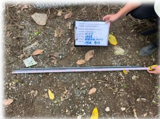
鋼筋取樣(鋼筋各號數取1組)
