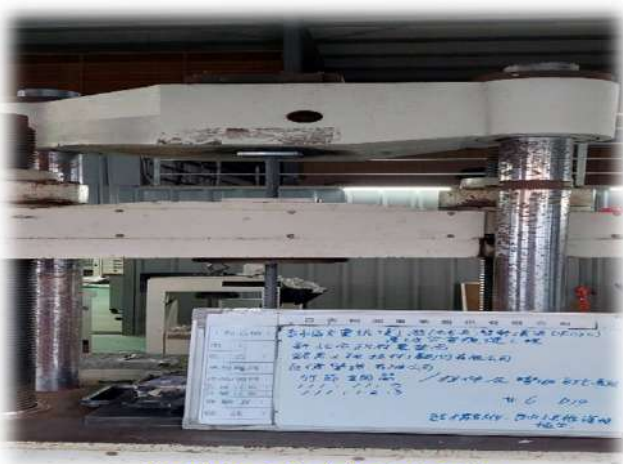
鋼筋拉伸試驗
