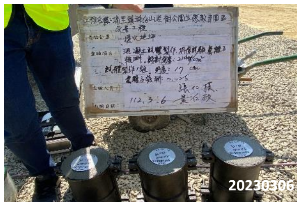
3 混凝土圓柱試體製作
