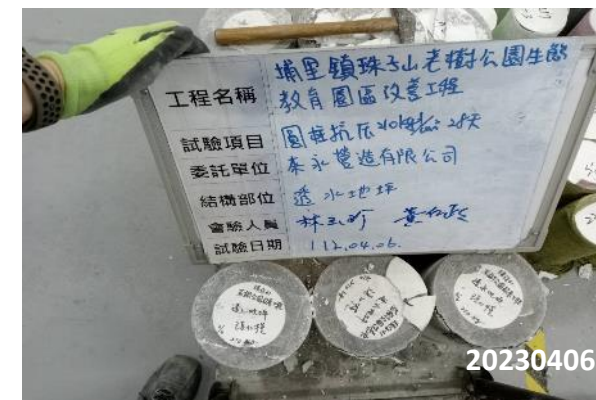
4 圓柱試體抗壓試驗
