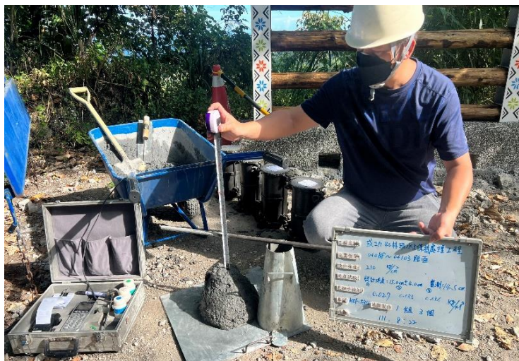
混凝土坍度及氯離子含量試驗
