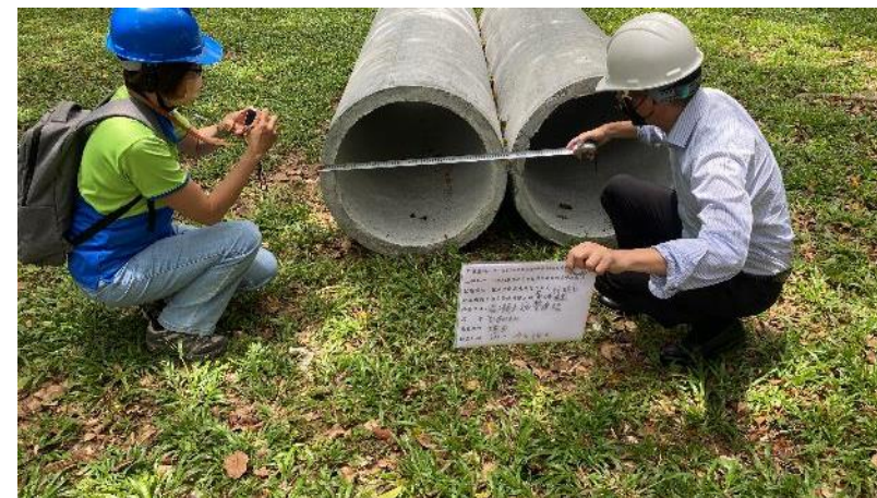
水泥涵管材料尺寸檢查
