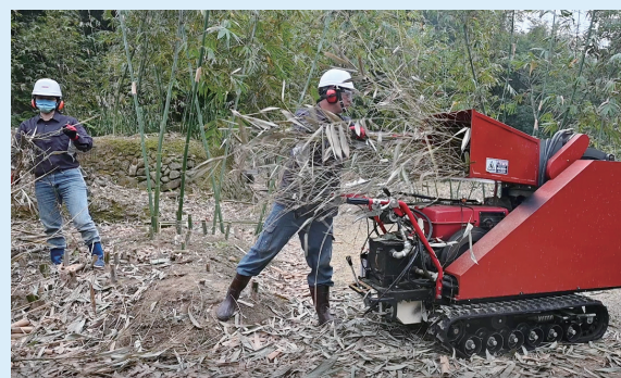
▲青農徐仕豪和王姿怡夫婦與本場合作以履帶式植物殘枝粉碎機示範粉碎老竹
