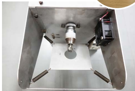
本場研發之大蒜磨根機的彈性安全護板及磨頭
