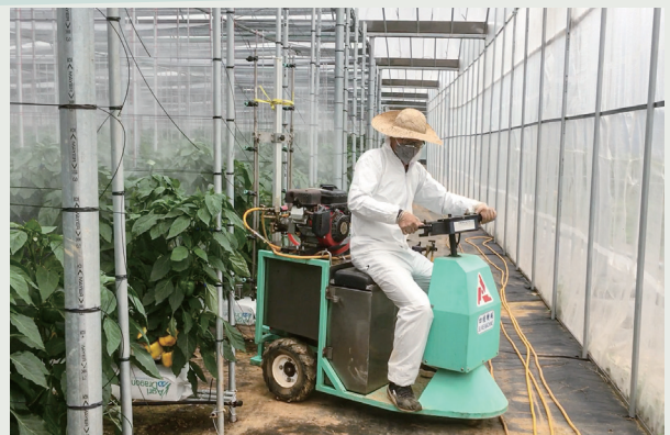
電動三輪自走式噴霧機，噴桿機構可向左右形成面狀噴霧，提高工作效率
