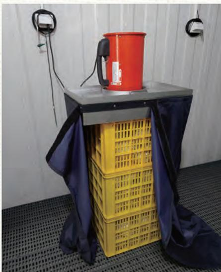
◆ 頂吸式壓差預冷時果籃整齊排列，於上方放置抽風扇形成壓差
