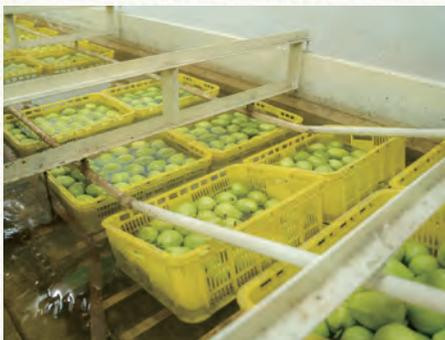
◆ 冰水預冷時去除外袋浸泡於冰水中進行降溫 (圖 / 林慧玲)
