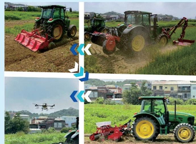
雜糧一貫化農機觀摩示範，先由舉臂錘刀式修剪機加上動力圓盤犁(右上)，將稻樁破碎並深翻表土層，接著由迴轉犁破碎土塊(左上)，最後透過播種機進行雜糧種子條播(右下)，並於種植期間透過植保機進行病蟲害管理作業(左下)。
