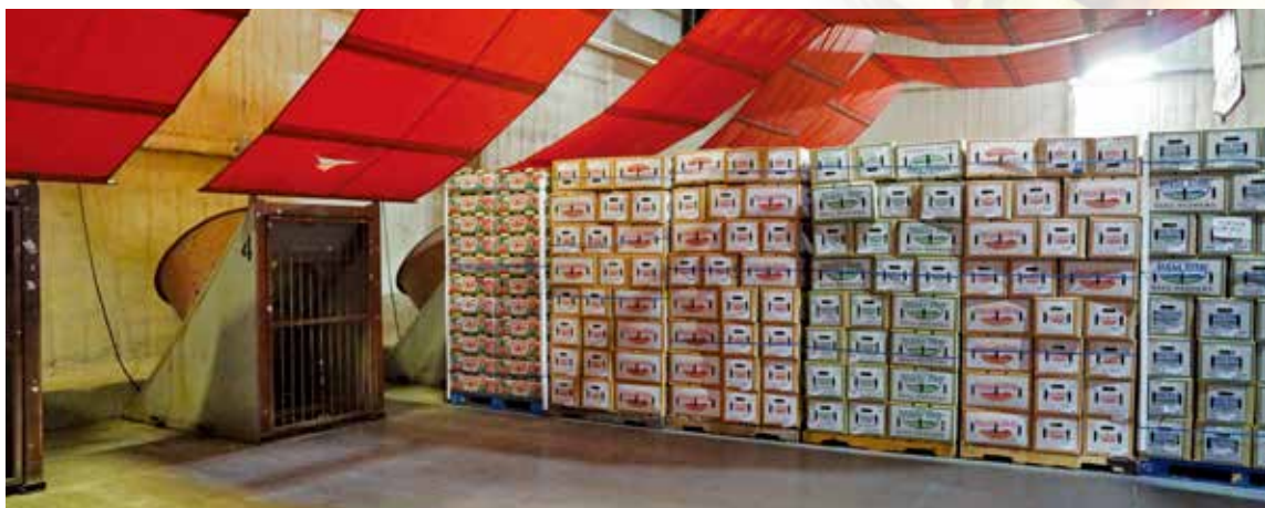
圖三、美國加州大型集理貨場進行甜椒壓差預冷情形。
