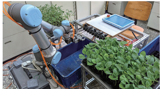
搭配機械手臂進行穗砧苗排列式夾持及斜切裝置之作業情形
