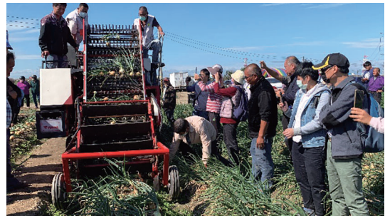
具有挖掘、篩土、剪葉及收集功能的洋蔥採收機作業情況
