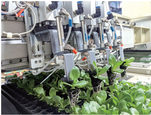
機械化作業將穴盤苗頂起、苗株夾取、苗株等距輸送、苗株放入水耕用保麗龍盤之承苗杯等4項自動化動作情形
