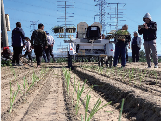
乘坐式全自動洋蔥移植機作業情況
