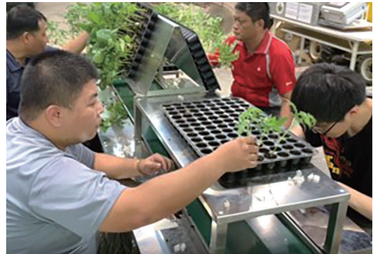
四人團隊合作操作輸送帶嫁接輔助機具之作業情形
