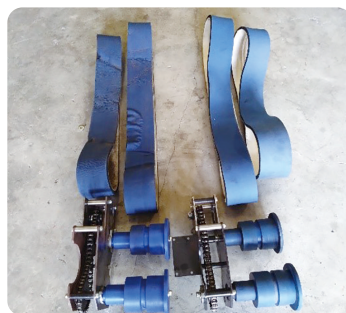
圖5. 韭菜採收機夾取部結構
