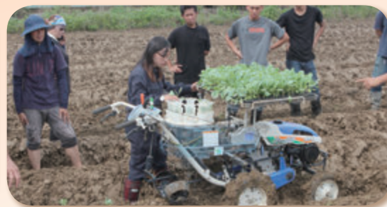
女性社員都可以輕鬆操作的蔬菜移植機，在田間進行示範教學。
