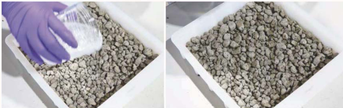
圖5.緩慢淋入膠液，避免快速倒入(左)；淋過膠液的火山浮石顏色會變深，可藉此判斷。
