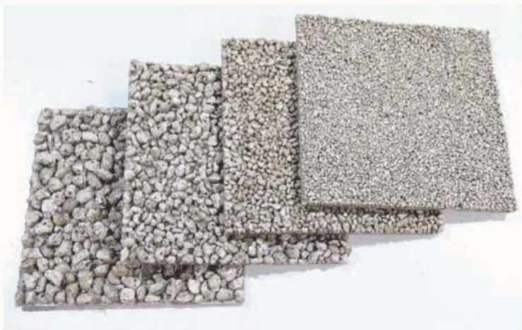
圖7. 火山浮石療育DIY手作植生板，使用不同大小顆粒製作，呈現出之外觀效果亦不同。
