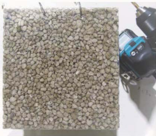
圖6. 硬化後即可翻出脫模，背面以電鑽鑽孔，置入掛勾後即可吊掛。
