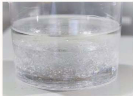
圖4.調製凝膠，一般而言為A劑加入B劑，調和均勻後備用。
