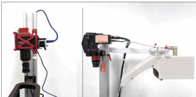
圖三、農試所購置之2台高光譜儀。左圖高光譜儀可偵測400 - 1,000奈米波段訊號，右圖儀器可偵測600 - 1,700奈米波段訊號。
