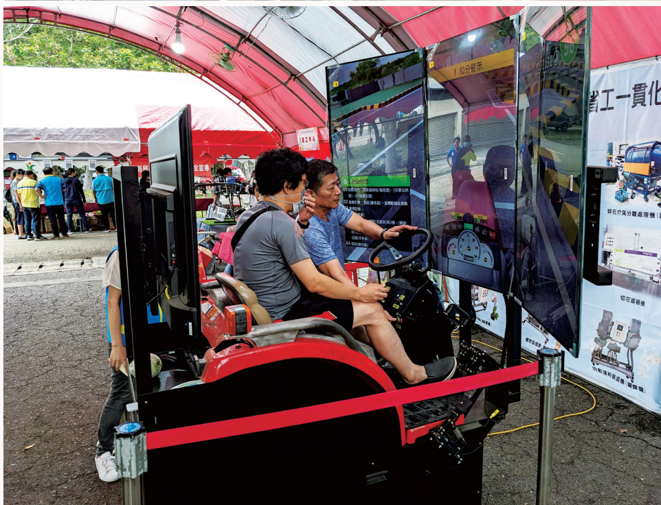
農用曳引機數位化訓練平台實際操作情形，透過虛實整合方式提升受訓者體感經驗累積。
