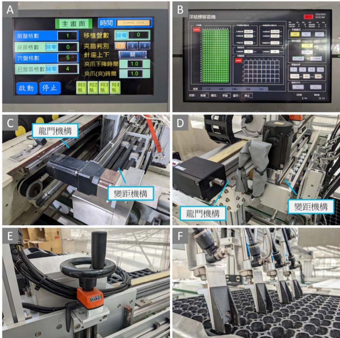
圖七、2 型水耕洋桔梗自動移植機之規格差異(A)原型機 1 代之人機介面；(B)原型機 2 代之人機介面；(C)原型機 1 代之變距及龍門機構；(D)原型機 2 代之變距及龍門機構；(E)原型機 2 代設置 Z 軸調整器；(F)Z 軸調整器調整植物抓取裝置與穴盤之距離。
