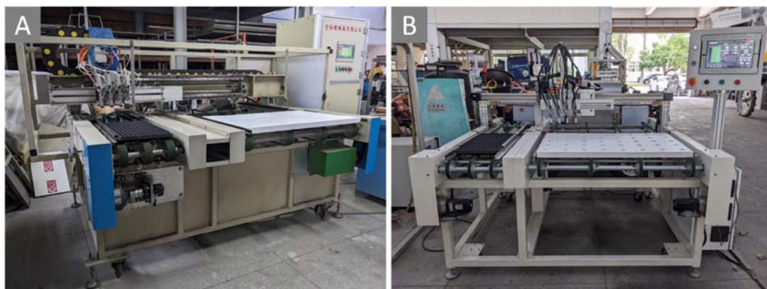
圖六、水耕洋桔梗自動移植機(A)原型機 1 代；(B)原型機 2 代。
