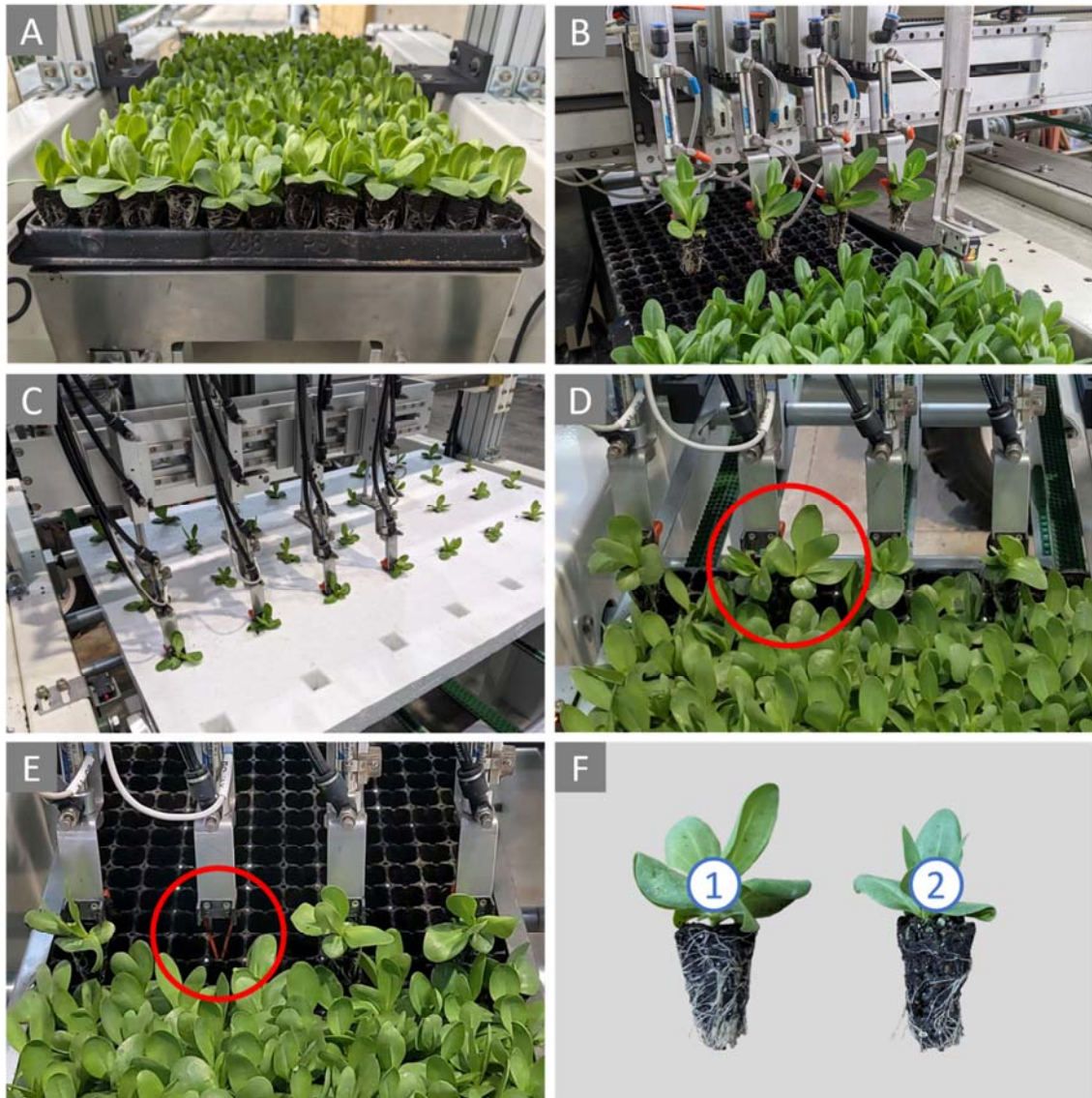
圖八、水耕洋桔梗自動移植機之作業情況(A)成功頂起苗株；(B)成功夾取苗株；(C)成功移植苗株；(D)夾取複數苗株-紅圈；(E)未夾取苗株-紅圈；(F)苗株盤根情況影響移植成功率：①根系良好、②根系欠佳。
