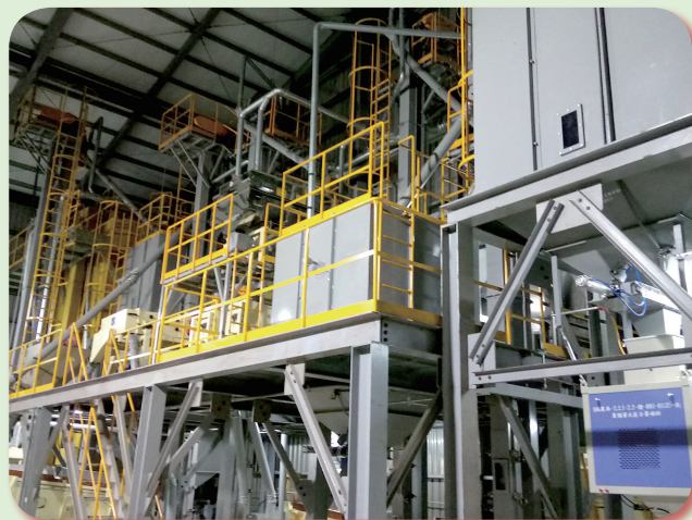
↑北部地區非基改大豆雜糧集貨處理中心，烘乾、去雜、磨光、色彩選別、分級、包裝及低溫貯藏，一條龍式處理流程。
