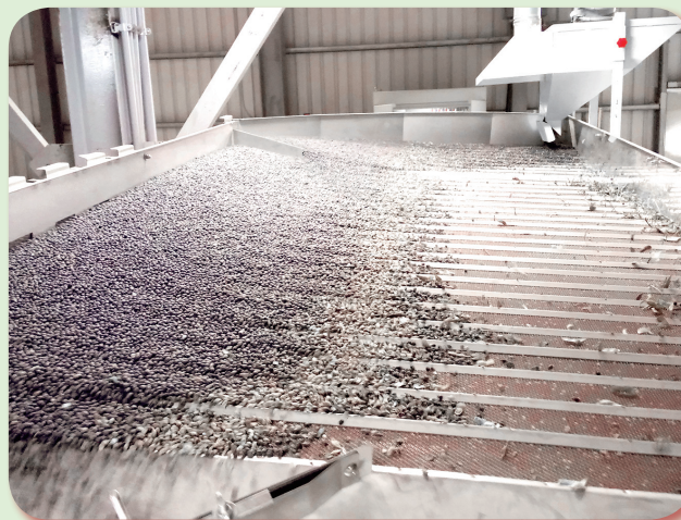
↑比重(選石)機，藉由大豆與雜質比重不同以振動方式進行去雜。
