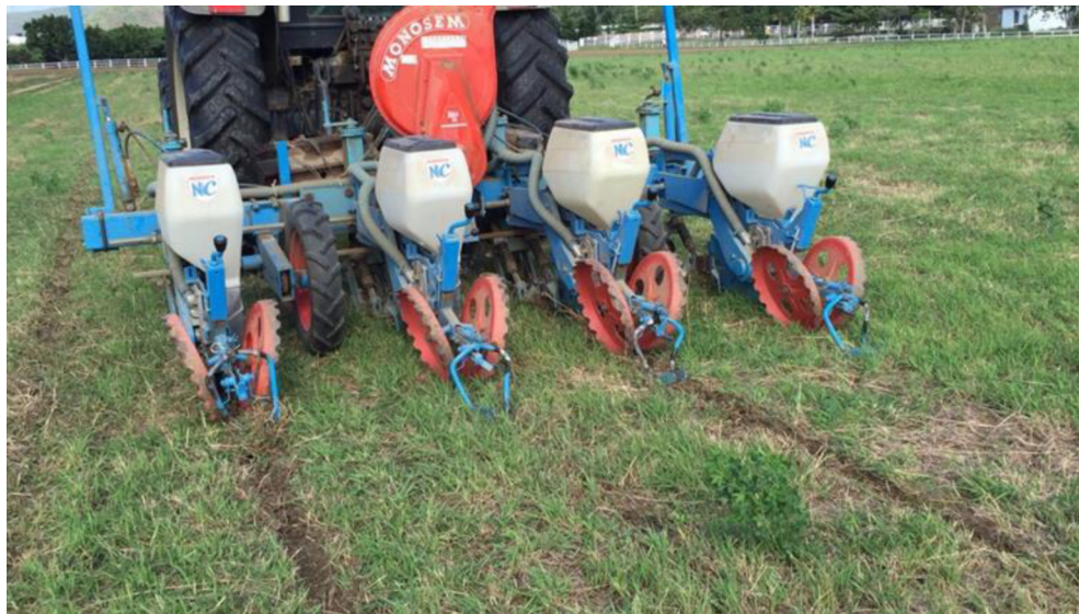
圖 1. 不耕犁草地間植播種套組。套組含破土、切溝、下種、覆土及鎮壓功能。
