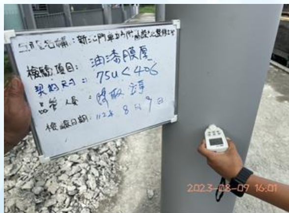
油漆底漆膜厚檢測-75u
