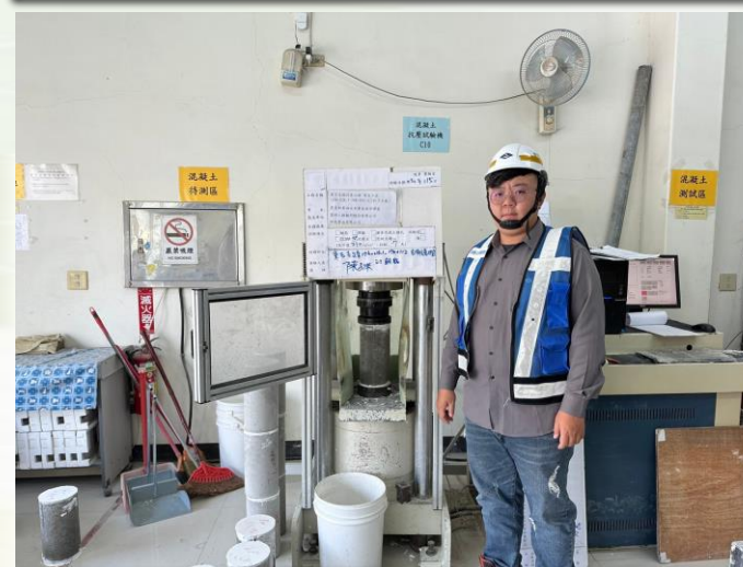
混凝土試體抗壓
