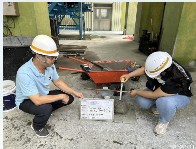
混凝土試體取樣
