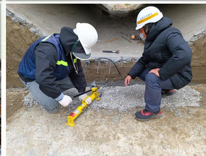
植筋拉拔試驗
