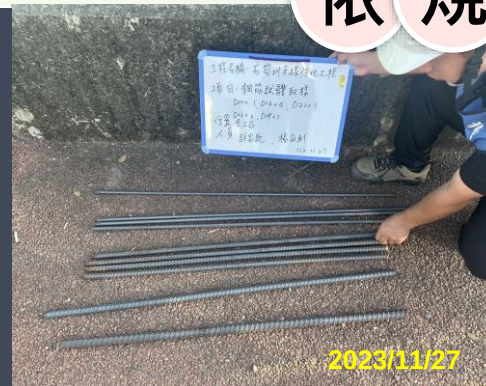
鋼筋抗拉取樣
