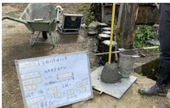
坍度、氯離子、圓柱試體試驗
