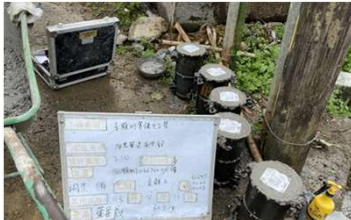
坍度、氯離子、圓柱試體試驗
