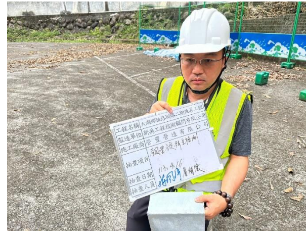
鋼管鍍鋅量取樣試驗
