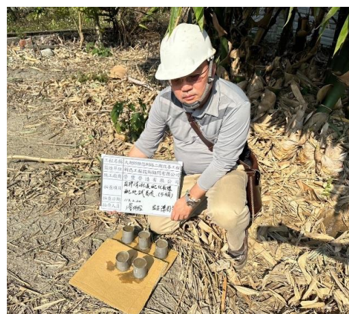
自拌清淤道混凝土取樣
