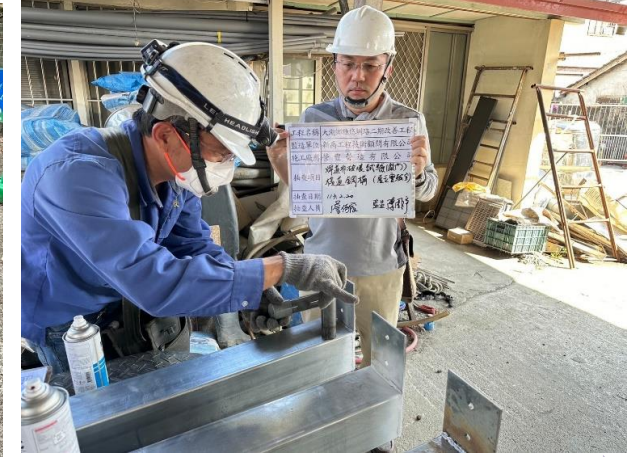
銲道非破壞檢測試驗
