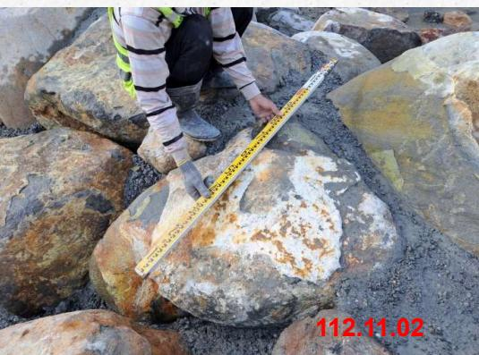
固床工原形塊石尺寸測量
