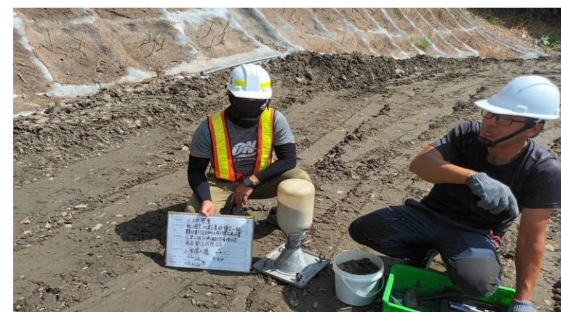
工地密度試體取樣試驗
