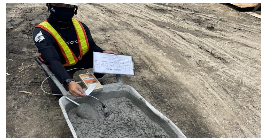
混凝土氯離子取樣試驗
