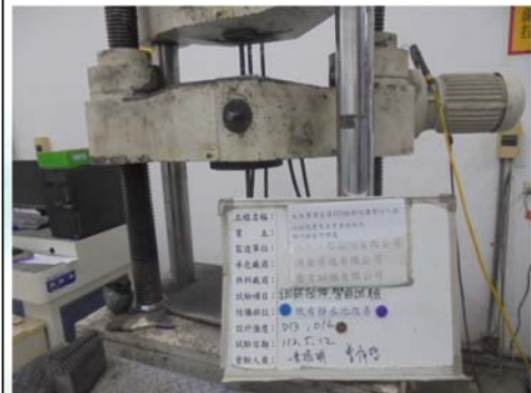
鋼筋拉伸試驗
