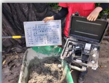
混凝土氯離子試驗
