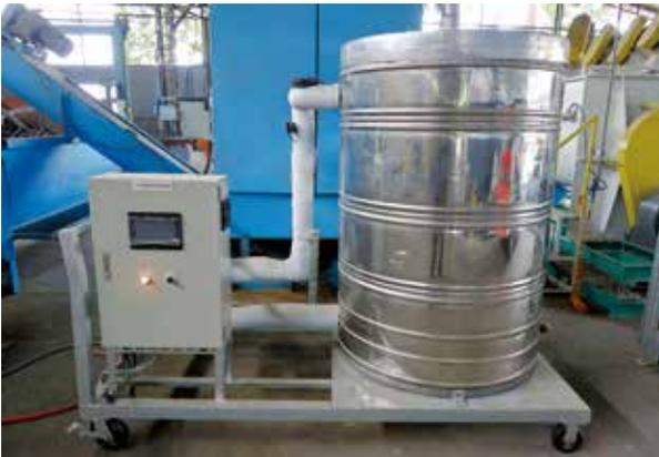
圖一、小型菇類堆肥發酵裝置實體圖。
