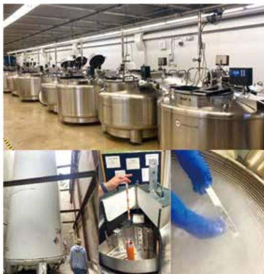
圖四、液態氮保存設施及材料，包含液態氮桶 (上)、液態氮儲存槽 (下左)、莖頂分生組織 (下中) 及休眠芽 (下右)。
