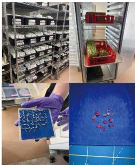
圖三、種子檢測及發芽試驗，包含種子乾燥室 (上左)、發芽室 (上右)、紙上法 (下左) 及TZ法染色 (下右)。
