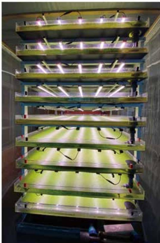
圖三、室內浮萍環控栽培堆疊設計 (Petersen et al. 2022)。
