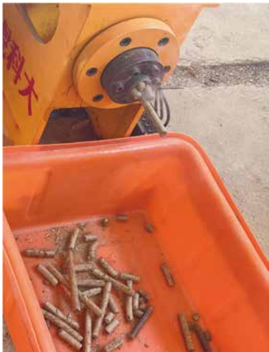
圖三、本所與虎尾科技大學合作，以杏鮑菇資源物製造之固態生質燃料顆粒。
