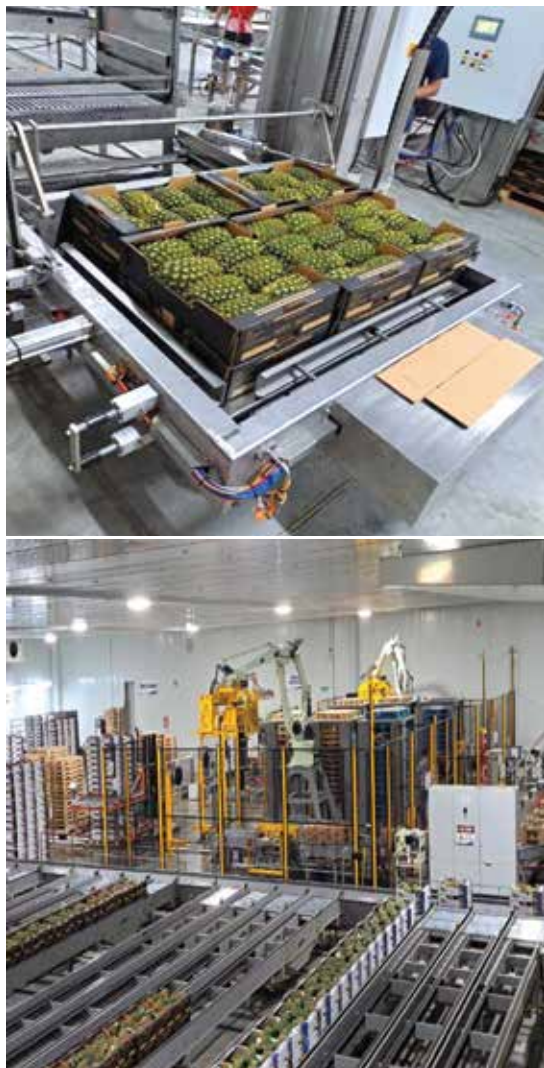
圖五、利用作業平臺及機械手臂進行打棧板可節省人力投入。
