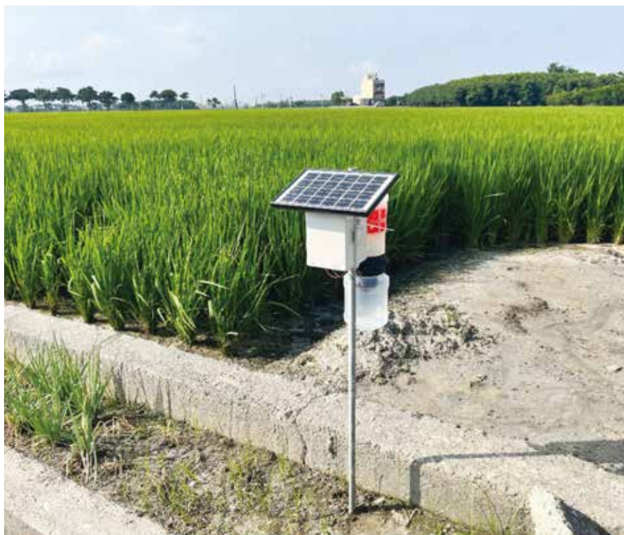
圖二、斜紋夜蛾自動監測陷阱設置於田間。
