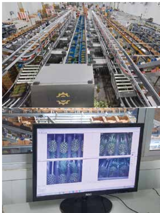
圖四、集貨包裝場可於分級流程包含果重及果實外觀品質影像辨識系統。
