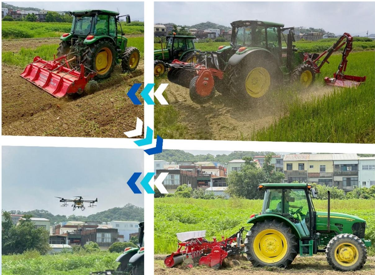
▲苗栗胡麻生產一貫化農機系列，由舉臂錘刀式修剪機加上動力圓盤犁（右上）、曳引機附掛迴轉犁（左上）、曳引機附掛播種機（右下）及植保機（左下）組成。
