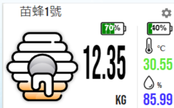
▲養蜂病蟲敵害智能監測系統新版使用者介面增加電量顯示。
