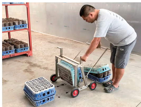
■ 青農劉啟葦測試小型試驗開發之菇包翻盤省力裝置
