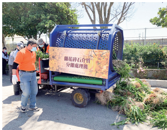
■ 農機研究室李安心技工示範操作車載型文心蘭碎石介質分離處理機作業方式
