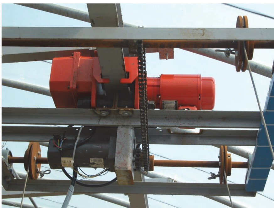
圖 4. 懸掛式軌道驅動馬達與空間及色彩校正框驅動馬達
