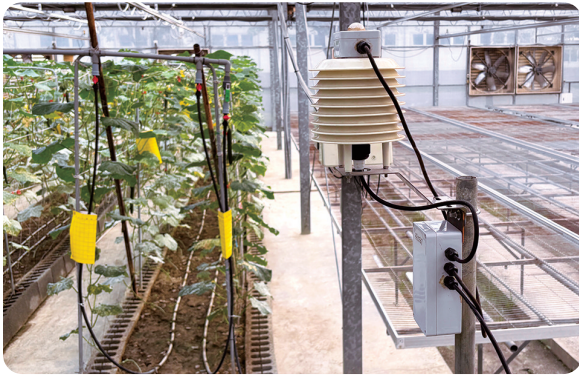
圖3. 結合溫度、濕度與光照感測器的物聯網感測設備。
