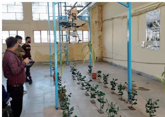
▲ 圖 3. 軌道吊掛無人機測試。
