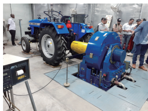
▲圖 9. PTO 動力測試設備。
