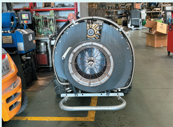
▲ 附掛式鼓風噴霧機左右兩組鼓風通道各自可調整風向角度
