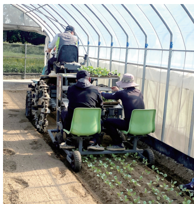
▲ 圖 1. 附掛式菜苗移植機操作情形。
