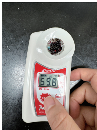
▲圖 13. 糖度計被用於作為抹醬濃縮程度品管工具。
