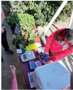
▲圖 7. 甘藷葉病毒快篩，田間取樣磨碎後，加入已配好之試劑，放入檢測儀中就可得知結果。
