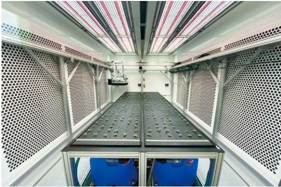
瓦赫寧根大學的第1個模組為環控生長室，上方有移動感測器，定時掃描植物生長狀態
