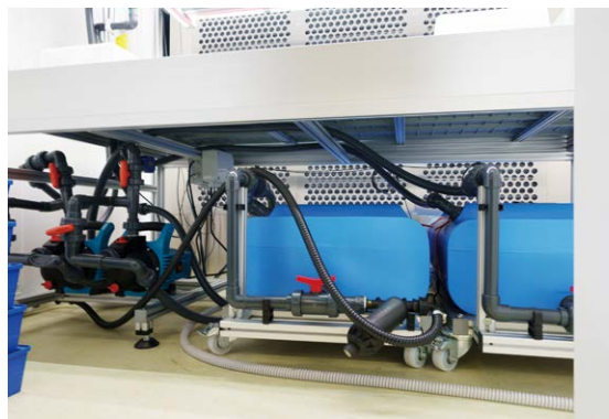
生長箱內的植物採潮汐灌溉法，生長架下的藍色桶子盛裝養液
