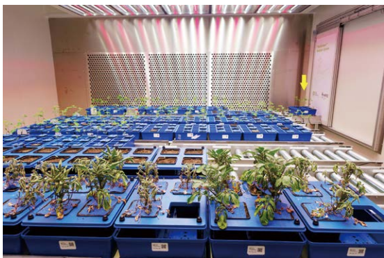
烏特勒支大學的第3個模組為環控生長箱，右上方箭頭所指的植株在軌道上正等待進入影像掃描區，上方為可獨立控制的生長燈
