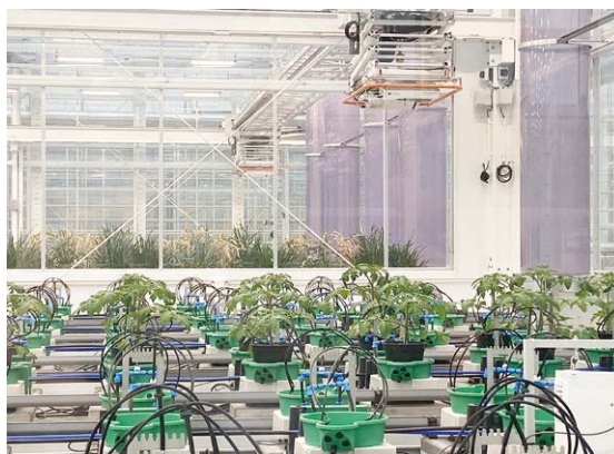
生長溫室裡養液自動澆灌及秤重系統，上方為掃描感測器
