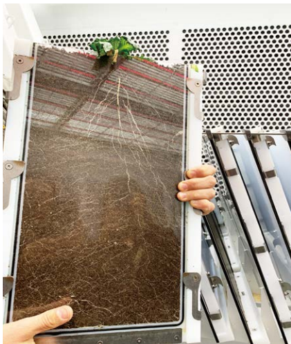
高通量根部表型系統，以土壤為介質，觀察根系生長
