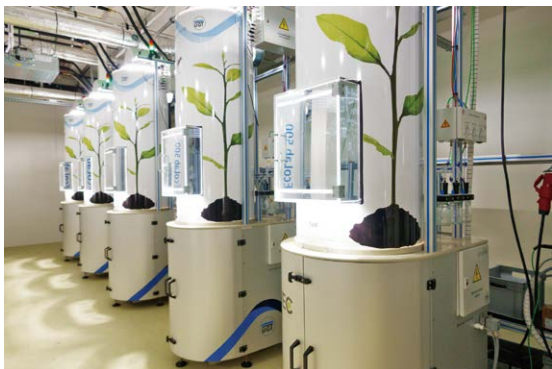
烏特勒支大學的第1個模組為完全封閉且受控的生態系統組成。可直接由上方壓克力透明窗觀察內部植物生長
