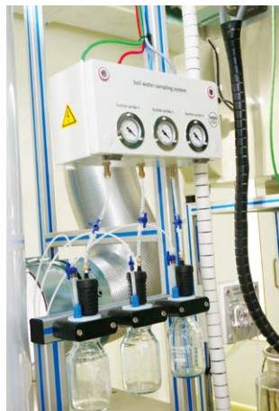
第1個模組可抽取地下部土壤的液體進行各項水質分析
