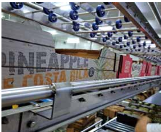
圖三、鳳梨箱平時貯放於2樓，包裝作業時向樓下輸送，於軌道加裝滾輪可克服樓層高差不足。
