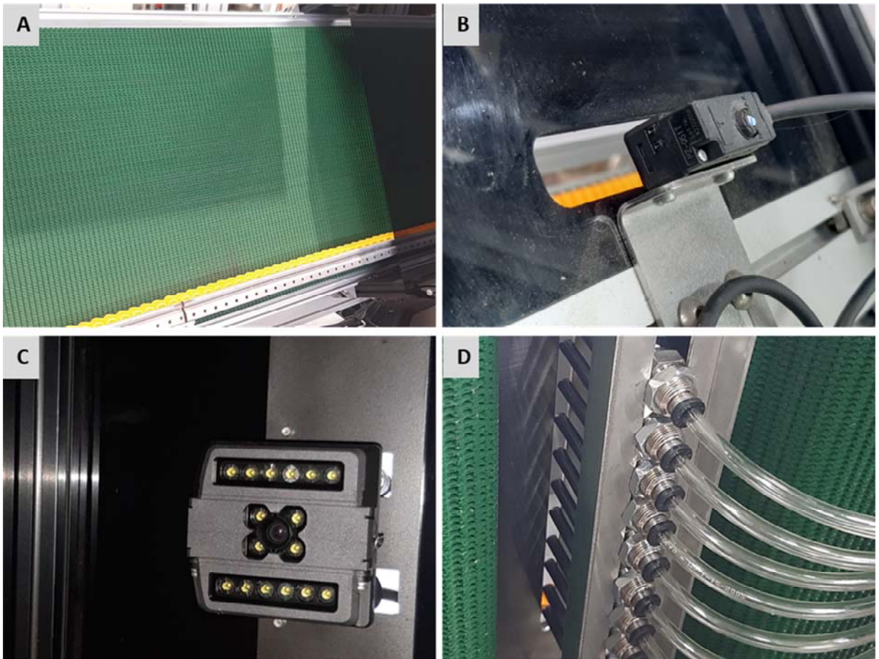
圖二、穴盤苗株篩選機設計重點：(A)傾斜式穴盤傳送結構；(B)穴列定位與驅動控制；(C)影像擷取分類模組；(D)氣動剔除模組。
