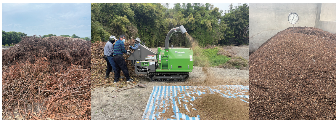
圖一、果木枝條經集中、破碎、堆積及發酵程序，生產堆肥成品。
