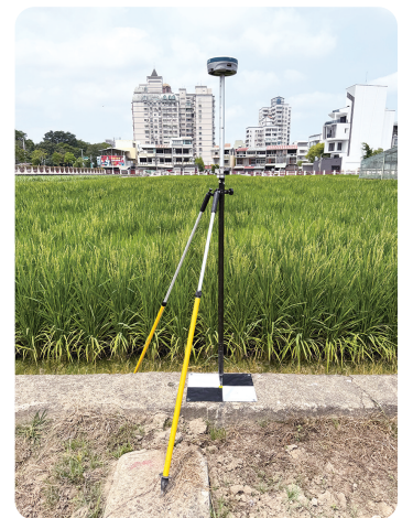
利用RTK-GPS標定地面控制點
