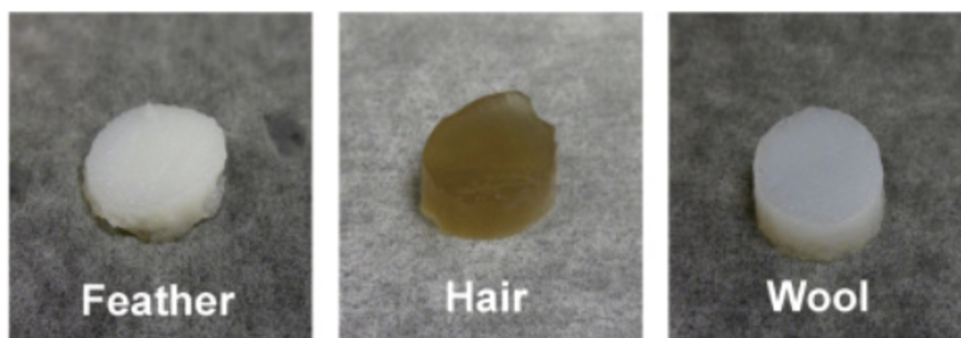
▲圖1. 以不同來源角蛋白製備之水凝膠 (Esparza et al. , 2018)
