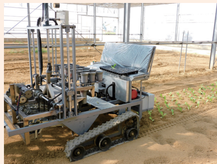
▲履帶式電動蔬菜移植機於溫室內作業情形，無引擎廢氣汙染及噪音產生之問題
