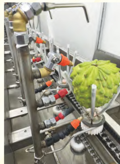
新型機械作業流程-III.果實以高壓空氣加強清潔並吹乾
