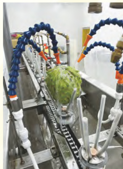
新型機械作業流程-II.果實經次氯酸水淋洗殺菌
