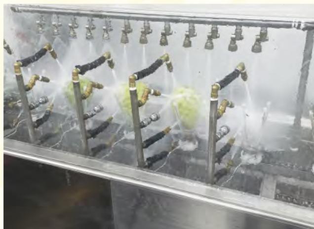
新型機械作業流程-I.果實以高壓水清洗
