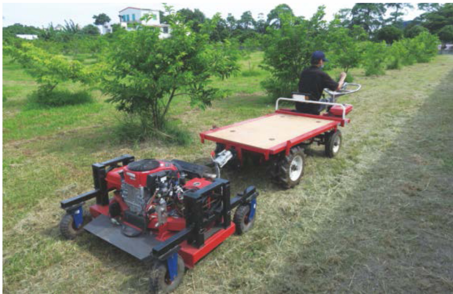
圖1. 附掛式割草裝置附掛於果園常用的小型搬運車 田間作業情形
