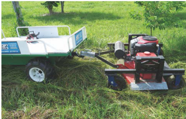
圖3.以一般拖車球結構附掛，操作簡單。
