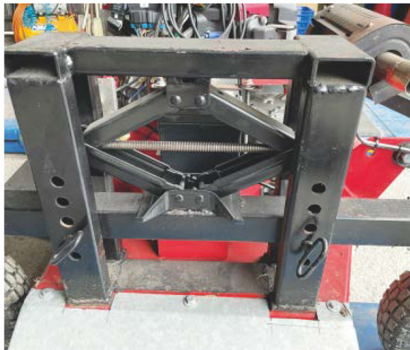
圖4.割草高度調整裝置以千斤頂及插銷組成
